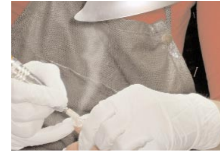
Angenehmes und freies Arbeiten durch Absaugung von oben (Maske tragen überflüssig)
